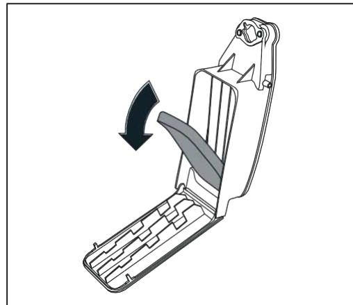
**11. Очистка фильтра топливного бака**
